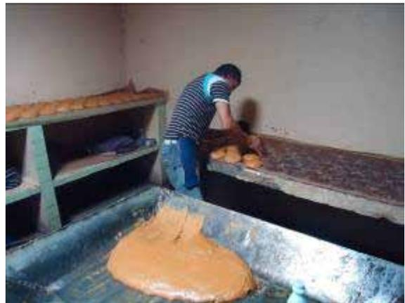
Para esta actividad el pesador utiliza unos cocos (moldes) con capacidad de 1 libra, toma la panela con los moldes y la ubica en un mesón, se seca en 10 minutos. Es un trabajo repetitivo; el mayor esfuerzo se realiza con las manos.
