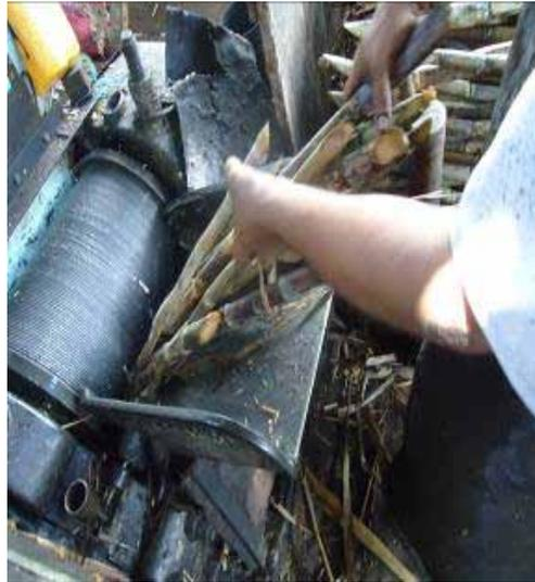
El tallador es el encargado de extraer la caña arrumada para llevarla hasta la máquina (trapiche o cañero) que tiene la capacidad de moler de 1000 a 1200 kilos por hora, la introduce en el trapiche, éste la traga y muele. El tallador expone sus brazos a ser atrapados.
