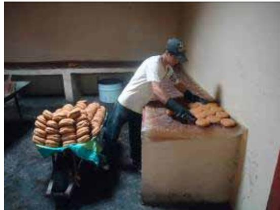
El metedor de panela recoge la panela del mesón con unos guantes para evitar quemarse y la organiza en una carretilla y la traslada al cuarto de almacenamiento.
