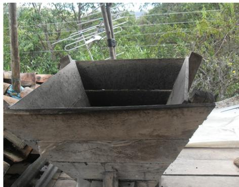
**7- DESPULPADO:** el café en cereza (fruto rojo) pasa a una maquina que se llama despulpadora donde se separa la pulpa del grano.
