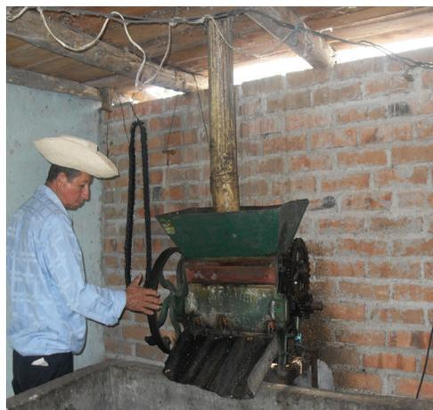
**8- LAVADO:** después de ser despulpado el grano pasa a un tanque de fermentación en donde es almacenado alrededor de 14 horas para descomponer el mucílago. Otra forma de retirar el mucílago es mediante métodos mecánicos, por medio del mucilagenador que consiste en pasar un flujo constante de café por el aparato que retira inmediatamente el mucílago quedando así listo para el secado. Foto del mucilagenador,.
