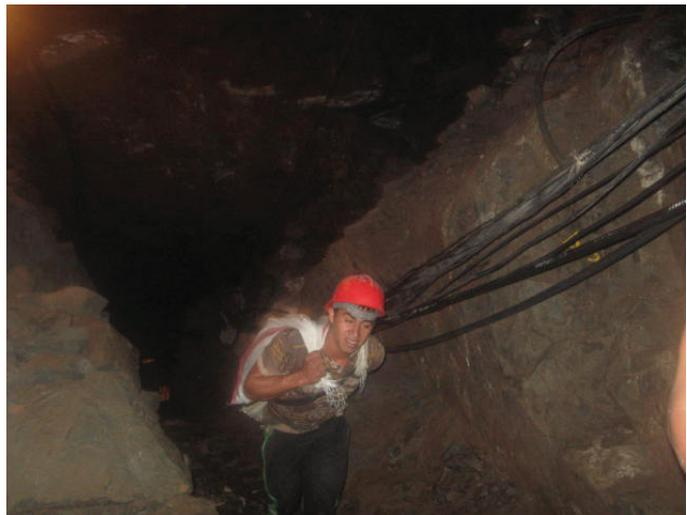
7. **VENTILACION Y DESAGUE:** No existe un sistema de ventilación ni de drenajes de la mina de acuerdo a las necesidades, para ninguno de los mineros, por lo que son frecuentes las demoras en la evacuación de gases, las molestias de polvos y las inundaciones en el frente.
