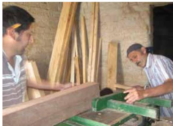
Para este proceso se utiliza la maquinaria industrial llamada circular para el corte de tablas, tiras, tajillos, tajos (cortes largos y cortos), bloques y también sirve para escoplear, en distintas medidas. Terminado este proceso se lleva la madera a la maquina industrial llamada planeadora para eliminar lo rustico de ella, por último se cepilla y se pule para un mejor acabado y para dar uniformidad a las distintas piezas que se utilizan para la elaboración de los muebles.
