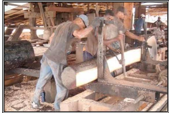
Después de los cortes, el marcador señala las medidas sobre los bloques ya cortados para su posterior separación y almacenamiento, la cual se realiza según el mercado que los requiera y las medidas específicas solicitadas por los compradores y obtener el producto final.
